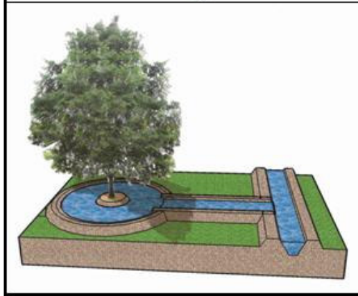
۵۲ شکل: د میوو د ونو لپاره د سطحې د اوبولو سیستم سرچینه: (2008) F.Sandor, RoP-Jalalabad, Afghanistan
