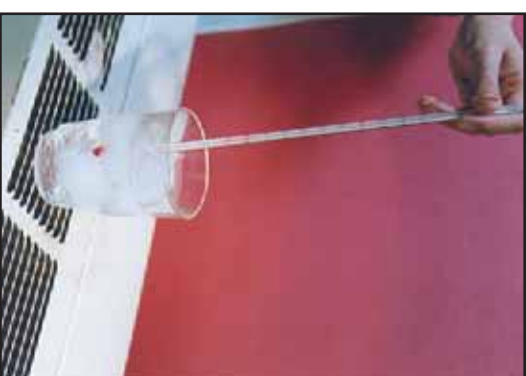
(۲۹-۱) شکل د یخ د ویلي کیدو ټکي اندازه کول
