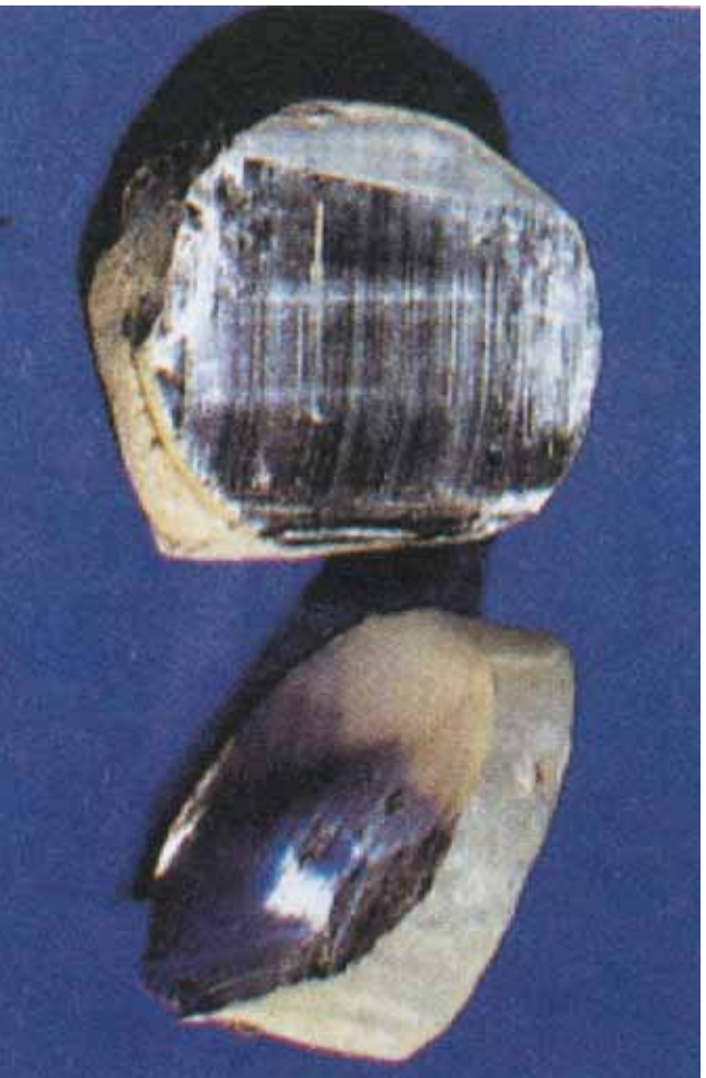
(۹-۳) شکل د سودنيم زنګ وهل د اکسيجن په واسطه
